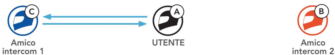
3. L'**utente (A)** può chiamare il **secondo amico intercom (B)** premendo due volte il **pulsante TAP**, oppure il **secondo amico intercom (B)** può unirsi alla conversazione intercom effettuando una chiamata intercom all'**utente (A)**.
