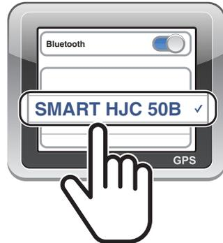
**Nota:** se si accoppia il dispositivo GPS tramite accoppiamento GPS, le sue istruzioni non interrompono le conversazioni Mesh Intercom, ma si sovrappongono ad esse. Le conversazioni intercom Bluetooth vengono interrotte dalle istruzioni GPS.
