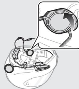
7. Introduzca la placa posterior del módulo de botones entre el armazón y el EPS del lateral izquierdo del casco.
