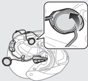
7. Inserire la piastra posteriore del modulo pulsanti fra la calotta e l'imbottitura EPS sul lato sinistro del casco.
