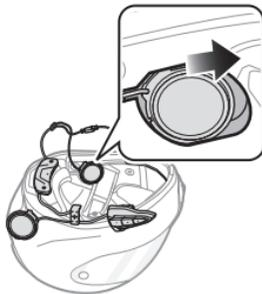
**[Una volta installata, la posizione dell'unità auricolare può essere regolata in base alla posizione dell'orecchio dell'utente]**
