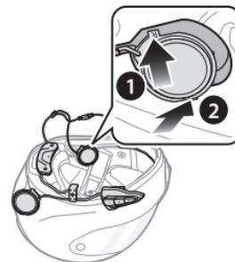
**[A installazione completata, assicurarsi che l'unità auricolare non prema contro il filo del microfono]**
