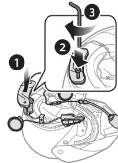
3. Inserire il microfono nella fessura destra dell'imbottitura in EPS del casco come mostrato di seguito.
