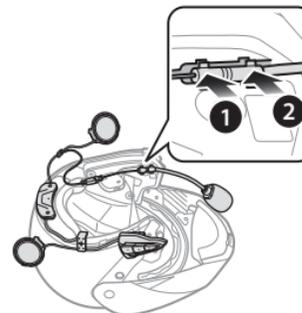
4. Insérez le crochet le plus long du module du haut-parleur droit dans l'orifice inférieur de la cavité pour haut-parleur. Lors de l'installation, placez le fil du microphone sous le crochet inférieur du module du haut-parleur. Insérez le crochet le plus court du module du haut-parleur droit dans l'orifice supérieur de la cavité pour haut-parleur.
