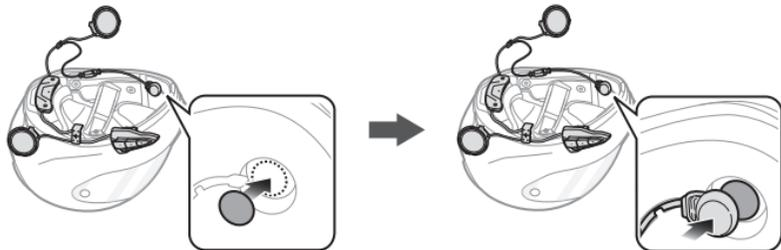
4. Insérez le crochet le plus long du module du haut-parleur droit dans l'orifice inférieur de la cavité pour haut-parleur. Lors de l'installation, placez le fil du microphone sous le crochet inférieur du module du haut-parleur. Insérez le crochet le plus court du module du haut-parleur droit dans l'orifice supérieur de la cavité pour haut-parleur.
