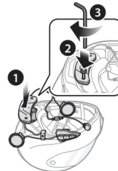
3. Retirez la protection de la bande adhésive de la fermeture scratch du microphone et fixez-la à l'intérieur de la mentonnière du casque moto. Fixez ensuite le microphone câblé sur la fermeture scratch.
