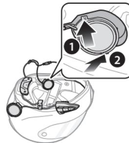
**[Vérifiez que le fil du microphone n'est pas coincé par le module du haut-parleur au moment de l'installation]**
