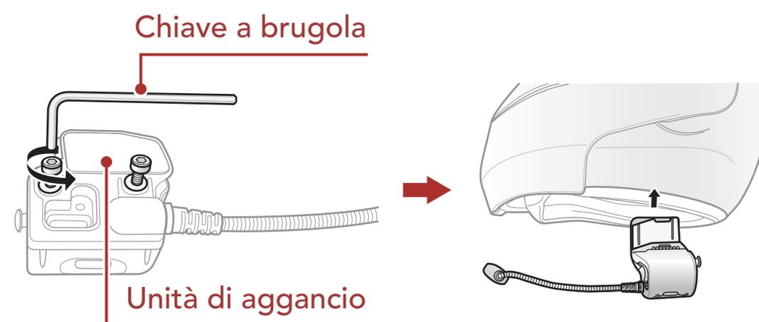
**Nota:** in base alle dimensioni e alla forma del casco, è possibile modificare lo spessore dell'imbottitura in gomma tra le piastre di aggancio utilizzando le due imbottiture in gomma aggiuntive incluse nella confezione. Per aumentare lo spessore generale, fissare l'imbottitura più spessa all'imbottitura in gomma originale oppure sostituire l'imbottitura in gomma originale con quella più spessa.
