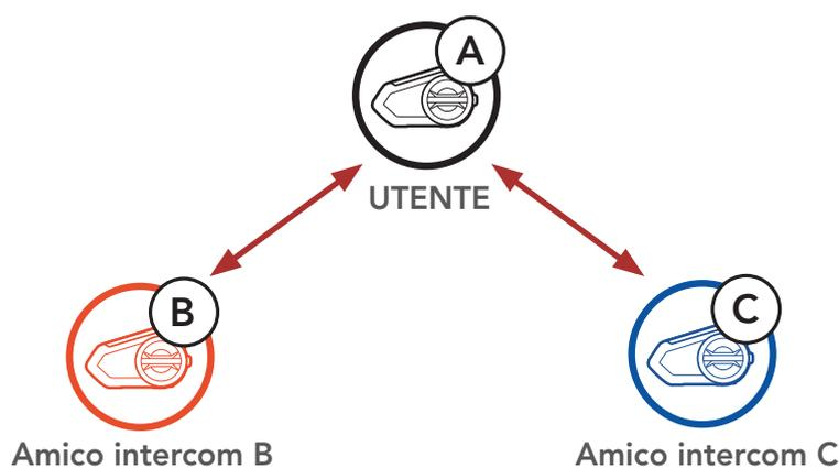
2. Avviare una conversazione intercom con uno dei due amici del gruppo intercom. Ad esempio, l'**utente (A)** può avviare una conversazione intercom con l'**amico intercom (B)**. In alternativa, l'**amico intercom (B)** può avviare una chiamata intercom con l'**utente (A)**.
