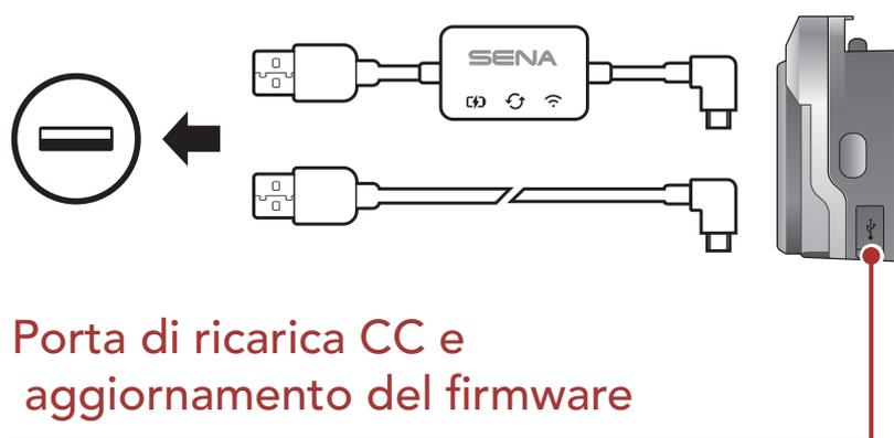
È possibile ricaricare la cuffia collegando il **WiFi Adapter** o un **Cavo USB alimentazione e trasferimento dati (USB-C)**.
