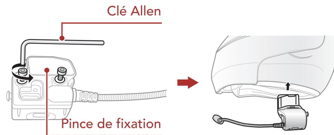
**Remarque :** selon la taille et la forme de votre casque, vous devrez peut-être changer l'épaisseur du tampon en caoutchouc entre les plaques de serrage en utilisant les deux tampons en caoutchouc supplémentaires dans la boîte. Pour augmenter l'épaisseur totale, fixez le plus mince au tampon en caoutchouc d'origine ou remettez le tampon en caoutchouc d'origine avec le plus épais.
