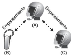
2. Inicie una conversación a través del intercomunicador con el auricular Bluetooth de otra marca (B) en su grupo del intercomunicador. Por ejemplo, usted (A) puede iniciar una conversación a través del intercomunicador con el auricular Bluetooth de otra marca (B). El auricular Bluetooth de otra marca (B) puede iniciar también una llamada a través del intercomunicador con usted (A).
