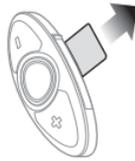
Per iniziare a utilizzare RC3, rimuovere la fettuccia di plastica dall'alloggiamento della batteria. Per accendere il dispositivo, premere il pulsante centrale. Per spegnere il dispositivo, tenere premuto il pulsante (+) e il pulsante centrale per 1 secondo.
