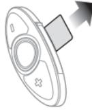
Pour commencer à utiliser la RC3, enlevez la bande en plastique qui protège l'emplacement pour batterie. Pour mettre l'appareil sous tension, appuyez sur le bouton central. Pour mettre l'appareil hors tension, maintenez le bouton (+) ou le bouton central appuyé pendant 1 seconde.
