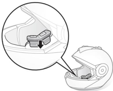
7. Masquez les fils derrière le rembourrage central et remettez en place les rembourrages internes.
