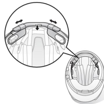
4. Retirez la protection des fermetures scratch pour haut-parleurs afin de découvrir la surface adhésive. Fixez ensuite les fermetures dans la cavité au niveau des oreilles du casque moto.
