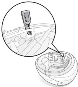
3. Insérez le module principal entre la coque externe et la coque interne. Alignez ses supports encliquetables avec les boutons-pression arrière.
