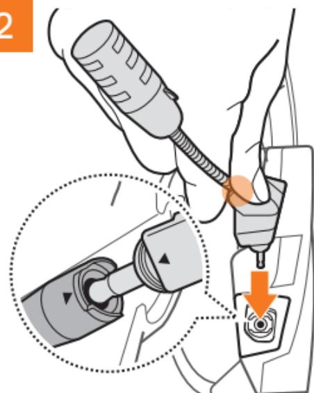
Installez le microphone en appuyant fermement sur la zone repérée par un cercle orange.
