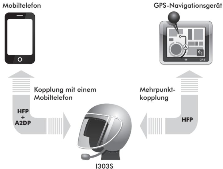
Mehrpunktkopplung des GPS-Navigationsgeräts
