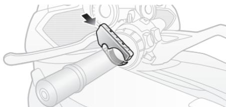
**Nota** Si el manillar necesita un mejor agarre para sujetar el RC4 en su sitio, coloque la banda de goma alrededor del manillar.
