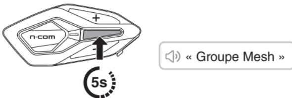
2. Lorsque le groupe Mesh est terminé, il bascule automatiquement de Open Mesh à Group Mesh.
