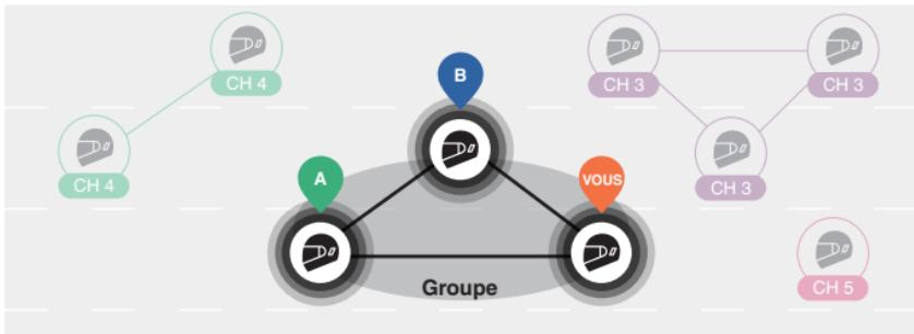
1. Les utilisateurs (vous, A et B) passent en groupe Mesh en appuyant sur le bouton Mesh Intercom pendant 5 secondes tout en restant en mode Open Mesh. Pour créer un Group Mesh, il n'est pas nécessaire de se trouver sur le même canal Open Mesh.
