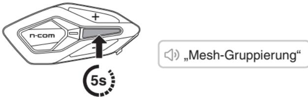
2. Nach Abschluss der Mesh-Gruppierung wechselt sie automatisch von Open Mesh zu Group Mesh.
