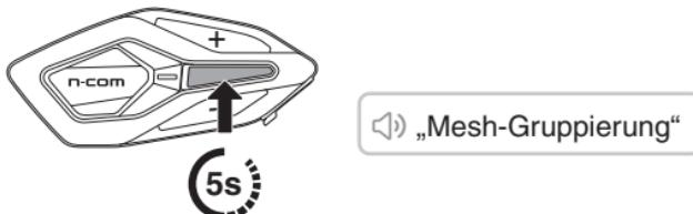
2. Wenn die Mesh-Gruppierung abgeschlossen ist, schließen sich die anderen Benutzer C und D automatisch dem Group Mesh an, während das Open Mesh bestehen bleibt.
