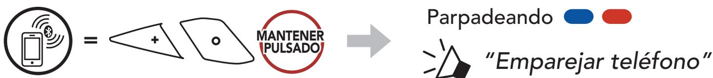
2. Seleccione **HelmLink** en la lista de dispositivos Bluetooth detectados. Si el teléfono móvil solicita un pin, introduzca 0000.
