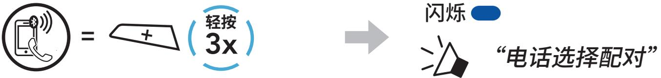
3. 在检测到的蓝牙设备列表中选择 **SMART HJC 50B**。如果您的手机要求输入 PIN，请输入 0000。
