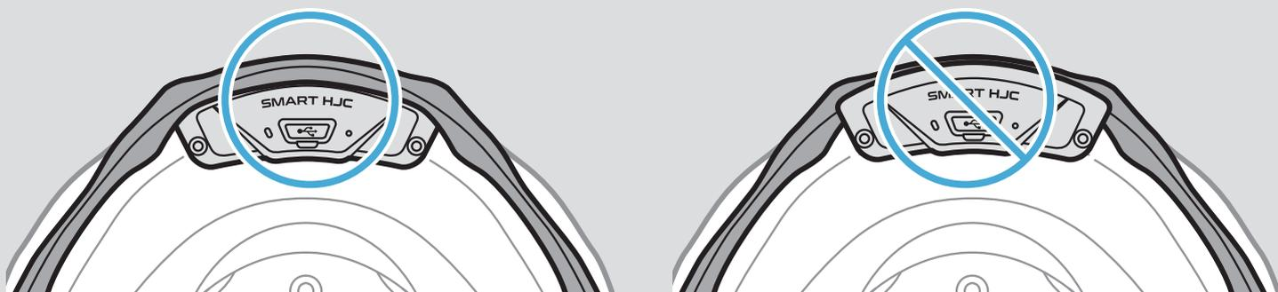
2. 若要整理蓝牙模块的连接线，请拉开橡胶护垫并将连接线放入凹槽中，如图所示。
