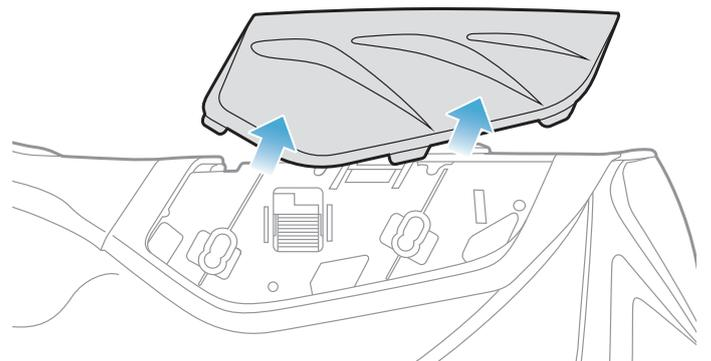
2. Lösen Sie die zwei kurzen Schrauben an der hinteren Abdeckung des Helms mit dem Inbusschlüssel aus dem Lieferumfang und nehmen Sie dann die Abdeckung ab.
