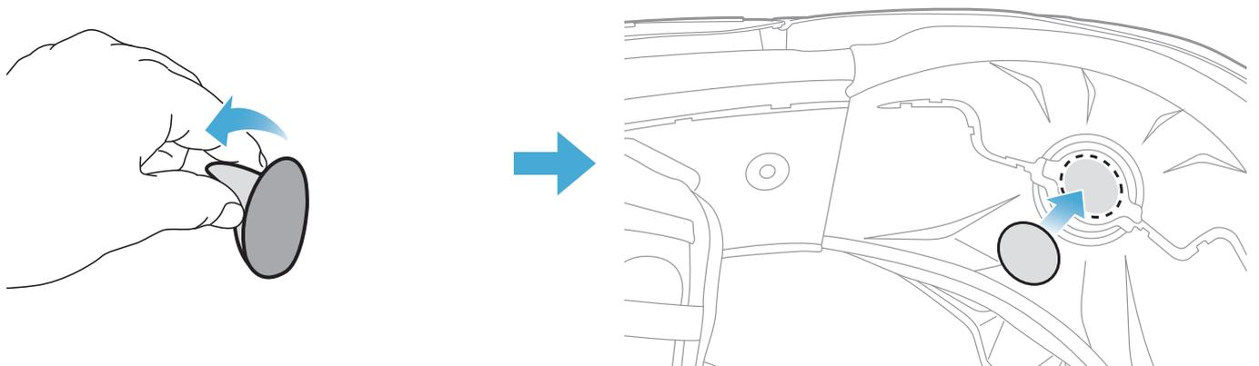
2. Bringen Sie das kabelgebundene Mikrofon am Klettverschluss an.
