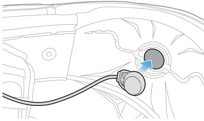
3. Legen Sie das Mikrofonkabel in die Vertiefung und verstauen Sie dann den Rest des Mikrofonkabels in der Lautsprecheröffnung, um die Lautsprechereinheit wie in der Abbildung gezeigt zu installieren.
