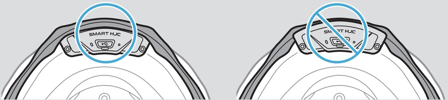
2. Um die Kabel des Bluetooth-Moduls zu verstauen, ziehen Sie den Gummischutz nach unten und legen Sie das Kabel wie in der Abbildung gezeigt in die Vertiefung.
