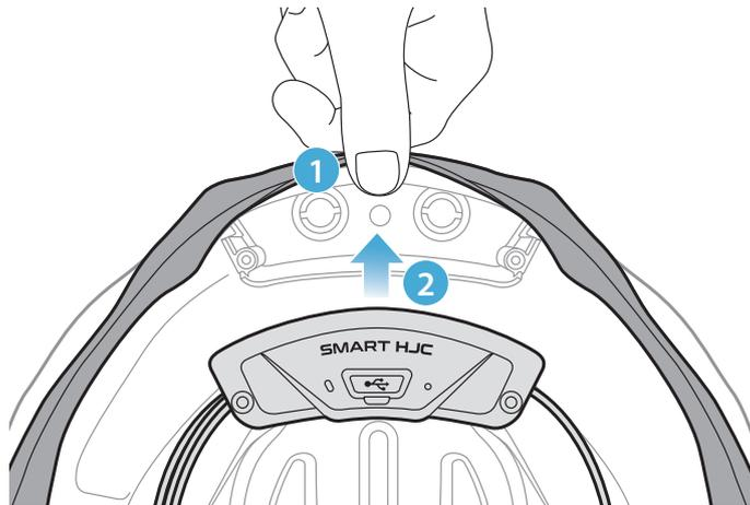
**Hinweis:** Achten Sie darauf, dass der Gummischutz des Helms nicht zwischen dem Bluetooth-Modul und der Aussparung eingeklemmt ist.
