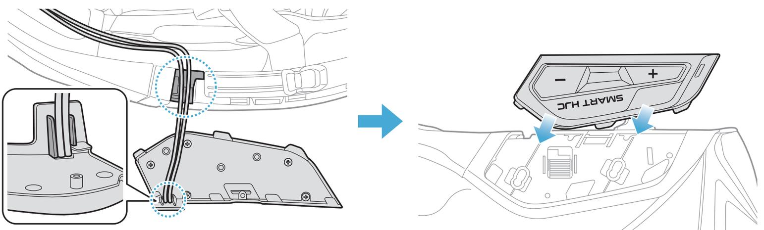
**Hinweis:** Vergewissern Sie sich, dass sich die Verkabelung des Tastenmoduls wie in der Abbildung gezeigt an der entsprechenden Vertiefung befindet.
