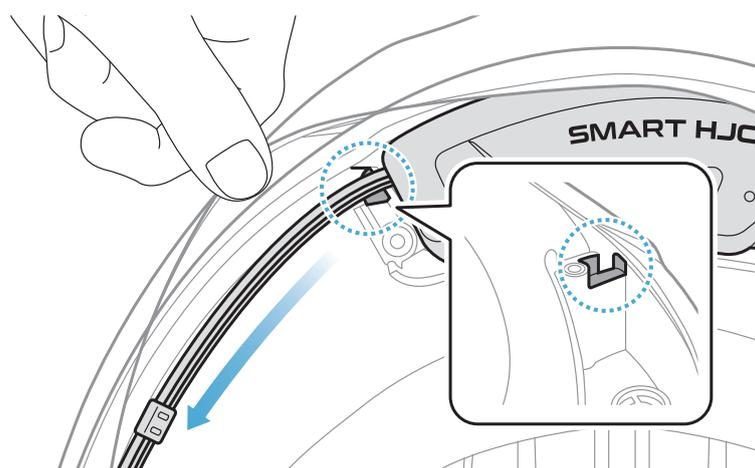
3. Verstauen Sie den Rest des Kabels in der Lücke unter dem Gummischutz des Helms.
