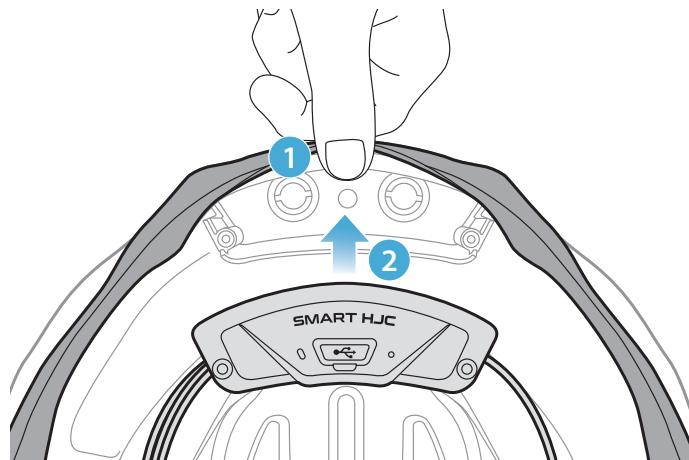
**注意：**确保头盔的橡胶护垫未卡在蓝牙模块和卡槽之间。
