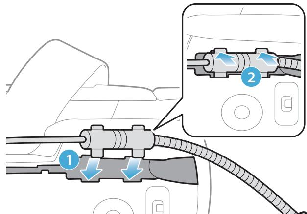
2. 将麦克风连接线放入凹槽中，然后将麦克风连接线的剩余部分放入扬声器匣中，以安装扬声器单元。
