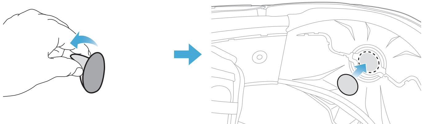
2. 将有线麦克风连接到粘扣带上。
