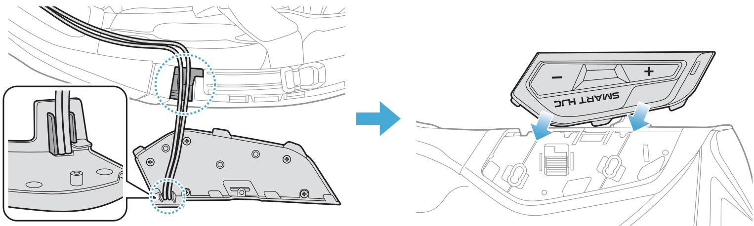
**注意：**确保按钮模块的连接线放置在相应的凹槽中，如图所示。
