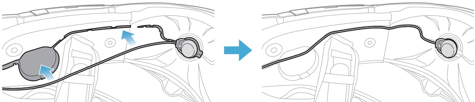
4. 将麦克风连接线上的箭头对齐，将麦克风连接线插入麦克风接头。
