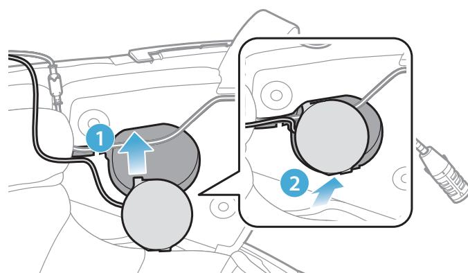
[确保安装时麦克风连接线没有压在扬声器单元下]
