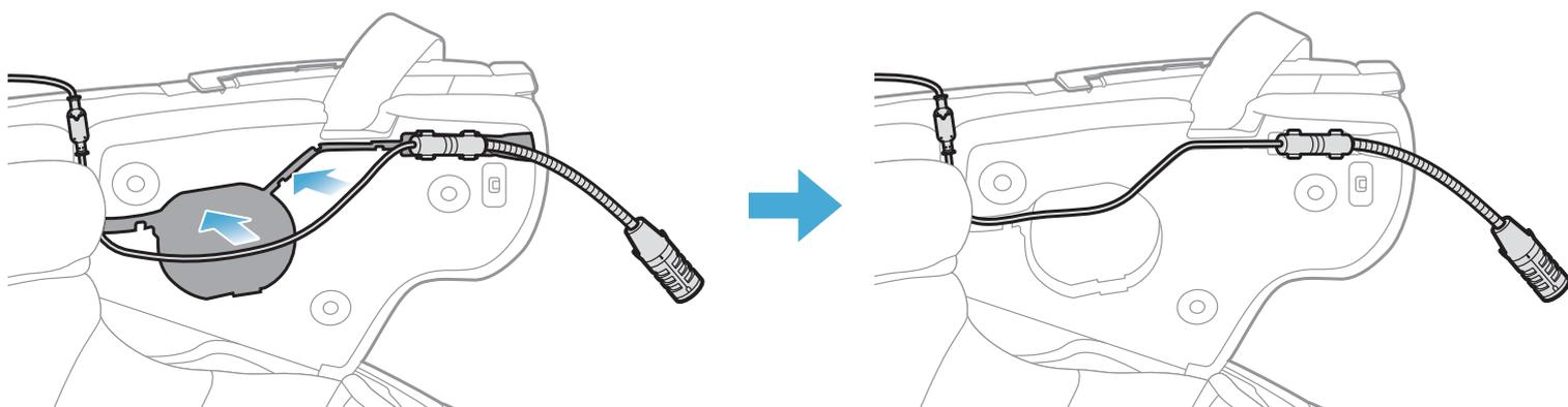
3. Allineare le frecce poste sul filo del microfono e inserirlo nel connettore per microfono.
