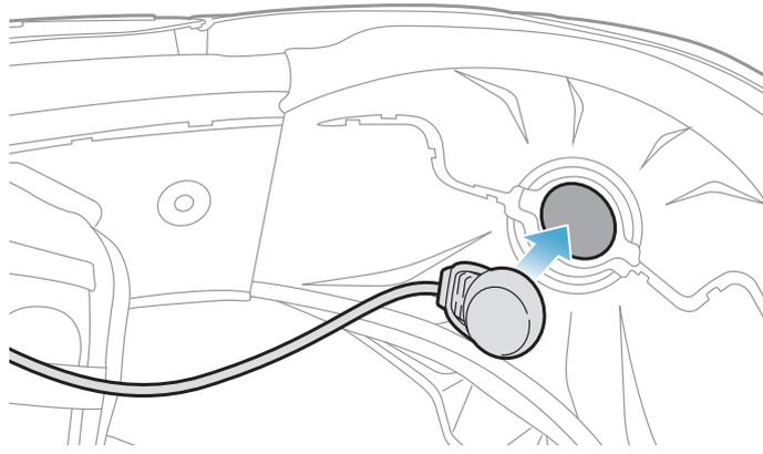
3. Collocare il cavo del microfono nella scanalatura e posizionare la porzione restante del filo del microfono nell'alloggiamento per auricolari per installare l'unità auricolare come mostrato nell'immagine.
