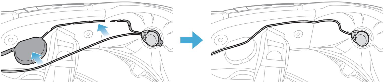
4. Allineare le frecce poste sul filo del microfono e inserirlo nel connettore per microfono.
