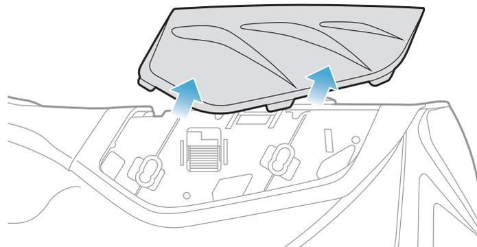
2. Allentare le due viti corte del coperchio posteriore del casco utilizzando la chiave a brugola in dotazione, quindi rimuovere il coperchio.
