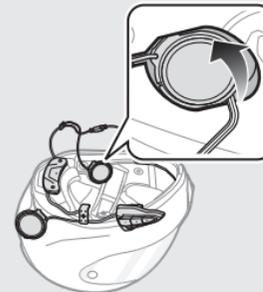
7. Inserire la piastra posteriore del modulo pulsanti fra la calotta e l'imbottitura EPS sul lato sinistro del casco.
