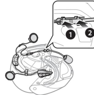
4. Inserire il gancio più lungo dell'unità auricolare destra nel foro inferiore dell'alloggiamento per auricolari. Durante l'installazione, posizionare il filo del microfono sotto il gancio inferiore dell'unità auricolare. Inserire il gancio più corto dell'unità auricolare destra nel foro superiore dell'alloggiamento per auricolari.
