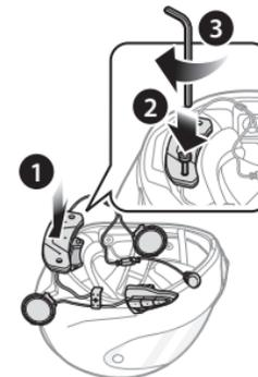
3. Rimuovere la pellicola protettiva della superficie adesiva dell'adesivo a strappo per microfono e fissarlo all'interno della mentoniera del casco. Successivamente, fissare il microfono con filo all'adesivo a strappo.
