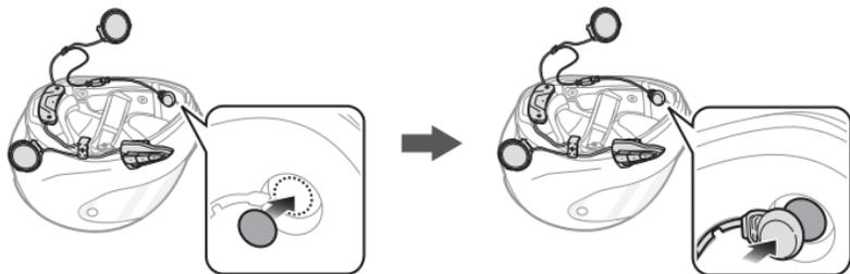
4. Inserire il gancio più lungo dell'unità auricolare destra nel foro inferiore dell'alloggiamento per auricolari. Durante l'installazione, posizionare il filo del microfono sotto il gancio inferiore dell'unità auricolare. Inserire il gancio più corto dell'unità auricolare destra nel foro superiore dell'alloggiamento per auricolari.
