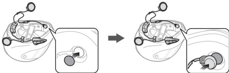
4. Introduzca el gancho más largo de la unidad de altavoz derecha en el orificio inferior del receptáculo del altavoz. Al realizar la instalación, coloque el cable del micrófono bajo el gancho inferior de la unidad del altavoz. Introduzca el gancho más corto de la unidad de altavoz derecha en el orificio superior del receptáculo del altavoz.
