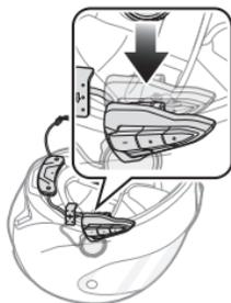
8. Deslice la presilla izquierda hacia el lado correspondiente entre el armazón externo y el EPS.
