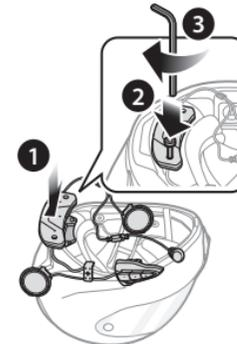
3. Retire la cubierta de la cinta adhesiva de la sujeción con cierre autoadherente de bucle para micrófono y péguela en el interior del protector para barbilla del casco. A continuación, coloque el micrófono con cable en la sujeción con cierre autoadherente de bucle.
