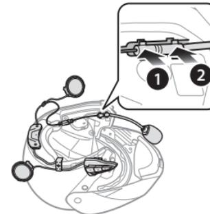
4. Introduzca el gancho más largo de la unidad de altavoz derecha en el orificio inferior del receptáculo del altavoz. Al realizar la instalación, coloque el cable del micrófono bajo el gancho inferior de la unidad del altavoz. Introduzca el gancho más corto de la unidad de altavoz derecha en el orificio superior del receptáculo del altavoz.
