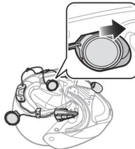
**[Una vez instalada, la posición de la unidad de altavoz se puede ajustar a la posición de la oreja del piloto]**
