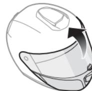
2. Afloje los dos tornillos cortos de la cubierta del casco con la llave Allen incluida y, a continuación, retire la cubierta.
