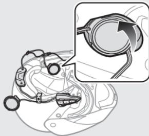
7. Introduzca la placa posterior del módulo de botones entre el armazón y el EPS del lateral izquierdo del casco.
